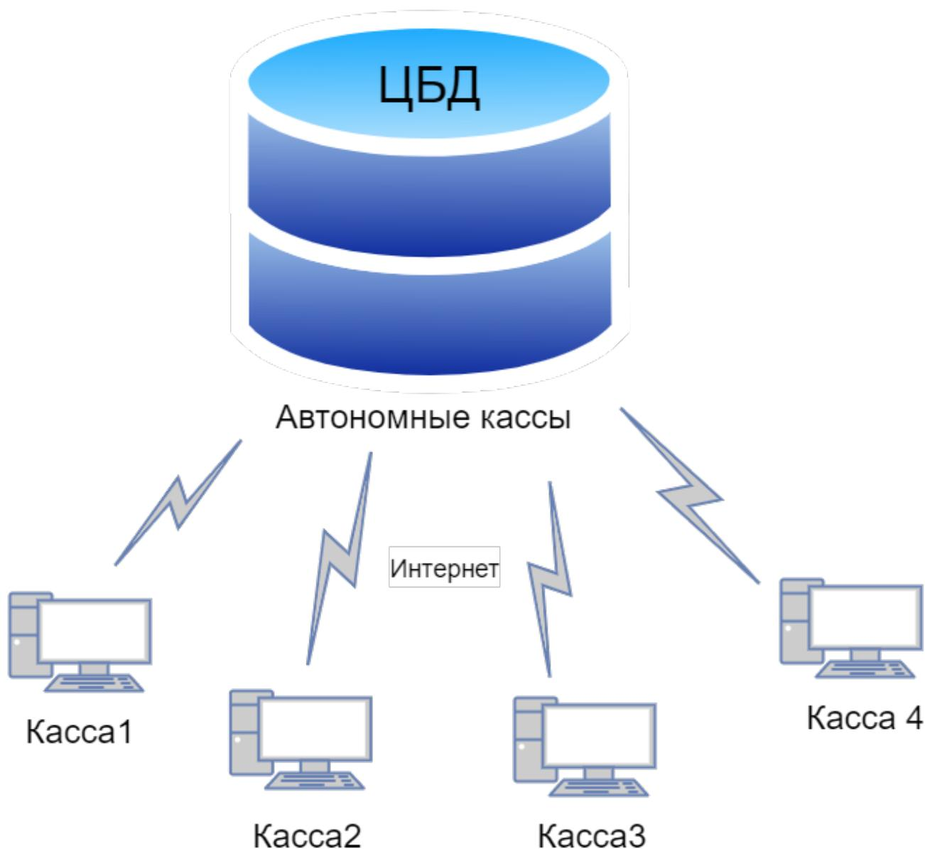
Кассы работают автономно. На кассовом компьютере разворачивается локальная БД и подключается кассовое оборудование (Фискальный регистратор, банковский PIN-пад).
