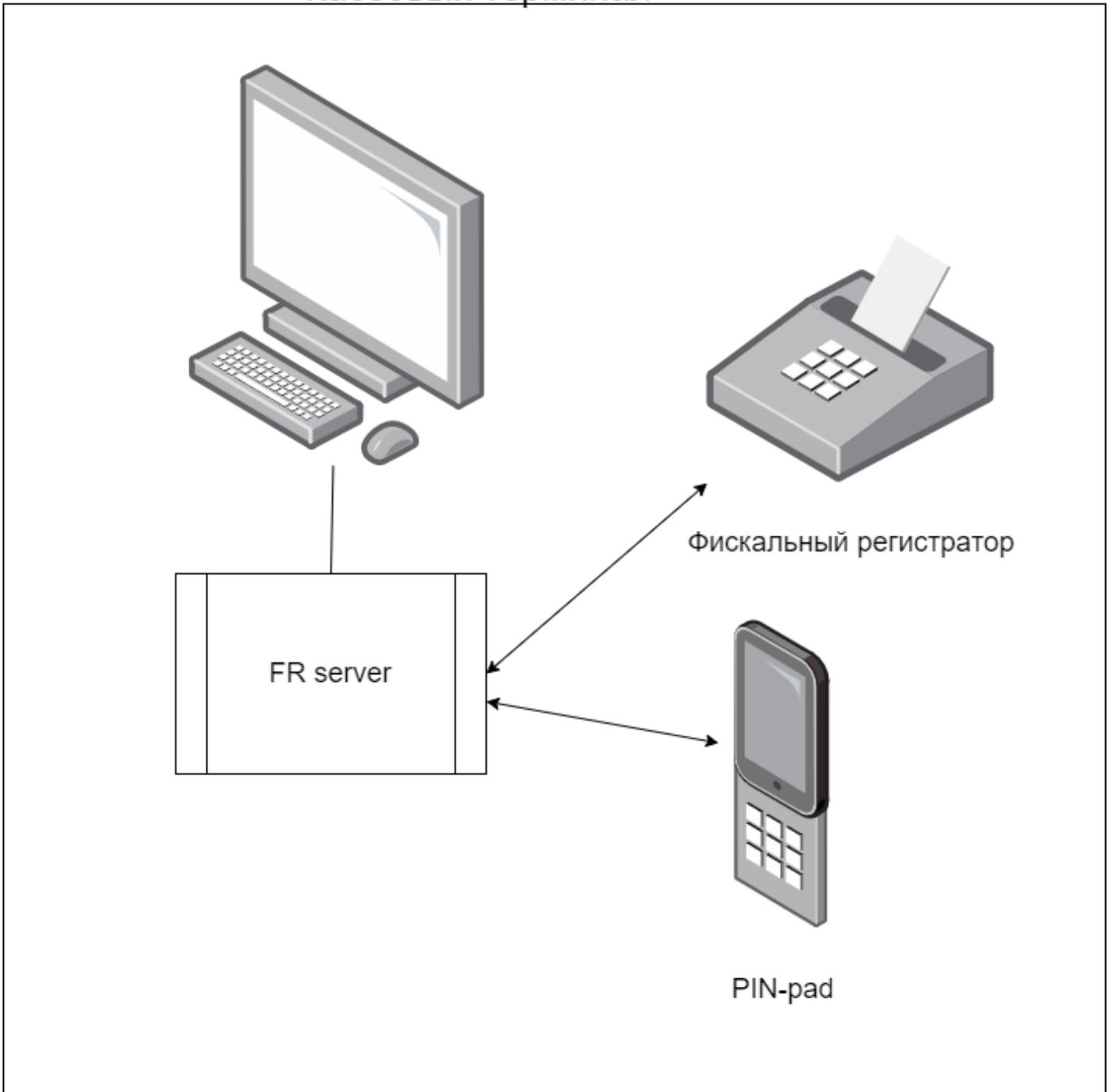
К кассовому терминалу подключаются Фискальный регистратор и банковский PIN-pad. Для работы с этим оборудованием на кассовом компьютере запускается программа FR server,
