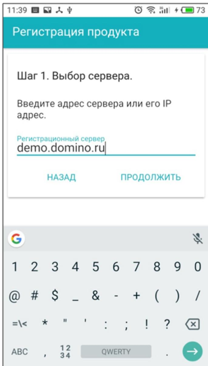
Здесь нужно ввести адрес рабочего сервера. Это может быть либо адрес, либо ip-адрес. После нажатия кнопки “Продолжить” программа проверяет доступность указанного сервера. Если адрес указан неверно или сервер по какой-либо причине недоступен, то будет выдано сообщение “Указанный сервер недоступен! Код ошибки:0” . Если проверка пройдена, то будет выполнен переход к следующему шагу регистрации.
